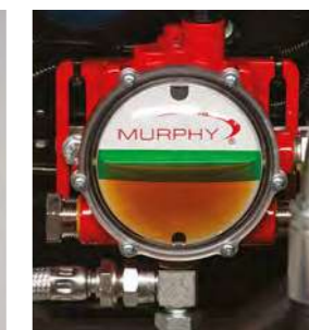
Sistema de mantenimiento de nivel de aceite
